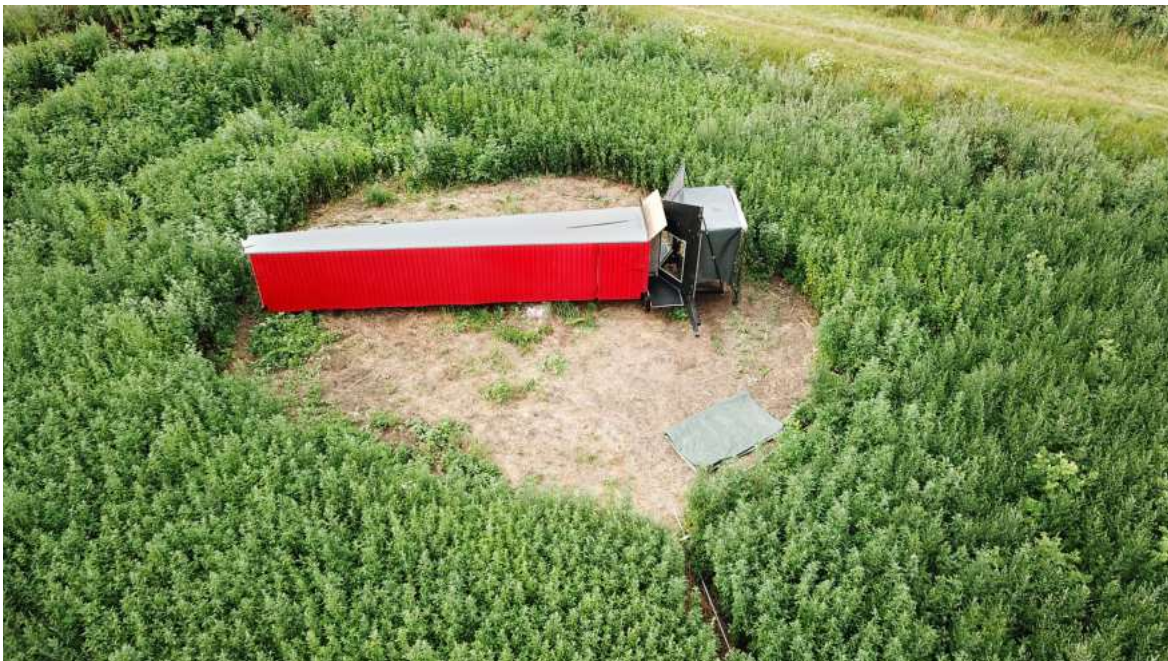
Der Flugtunnel der Biologischen Station Hohenau-Ringelsdorf vor Beginn der Forschungssaison bei noch unvollständiger Vegetationsentwicklung. Die kreisförmige Lichtung entspricht dem Schwenkbereich der Versuchsanlage, die drehbar gelagert ist, um die Sonne konstant «im Rücken» der Vögel zu halten. Die Vögel werden am schmalen Ende in den Tunnel gesetzt und starten sofort in Richtung der Prüfscheiben (rechts). Von einem Netz abgefangen, werden die Vögel unverletzt durch die seitliche Türe ins Freie entlassen.
