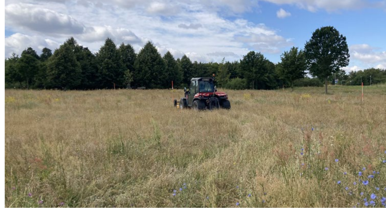
Die rotierenden Mähwerke des herkömmlichen Mulchers, wie er hier zu sehen ist, schädigen deutlich mehr Insekten als schneidende Mähwerke.
