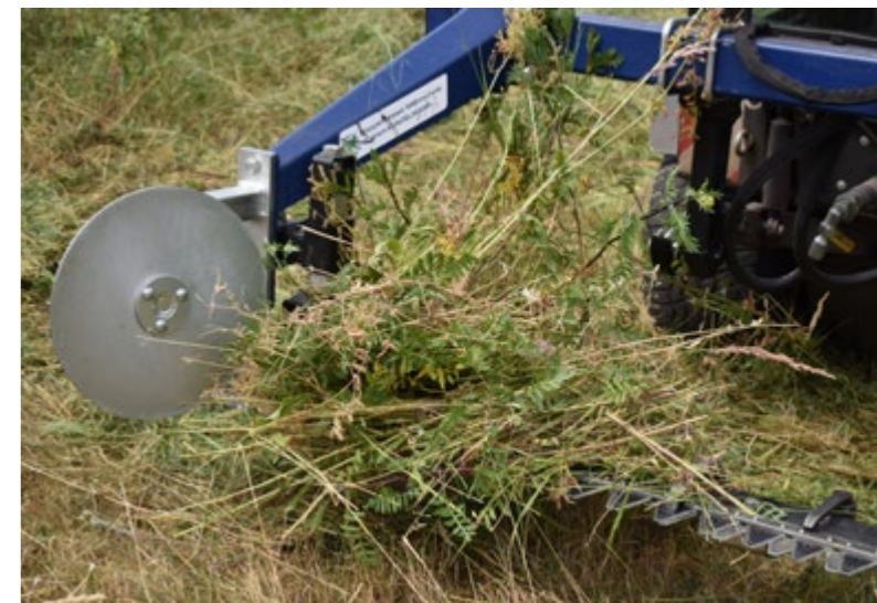
Balkenmäher häckseln das Mahdgut nicht klein. Das erhöht die Überlebenschancen von Insekten deutlich.
